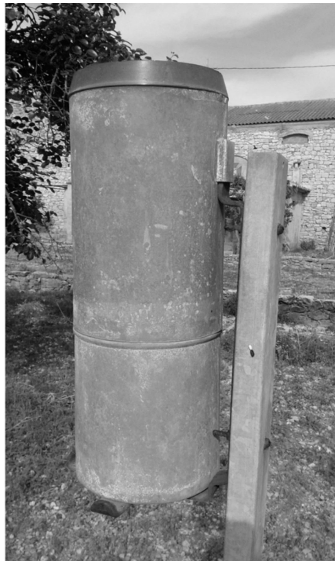
Imagen 11: pluviómetro Hellmann de la fábrica Yoldi de Atzeneta del Maestrat. 75 años de observaciones pluviométricas ininterrumpidas en la localidad.
